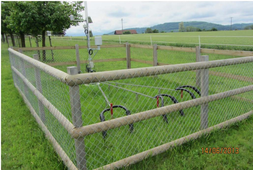
**Tensiometer im Boden mit Schutz um die Kabel. und Aluminiumschiene.**
