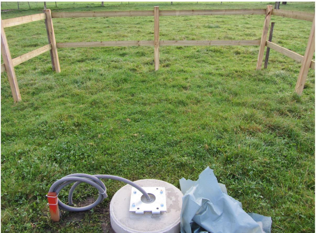
**Standort mit gesetzten Tensiometern. Pro Aluminiumschiene je ein Tensiometer in 20 und 35 cm Bodentiefe.**
